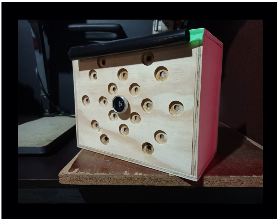
Cámara estenopeica con 19 estenopos. Construcción propia para la realización investigativa de EIDOS TEMPO
